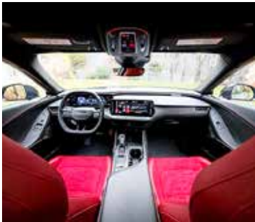
EN SU HABITÁCULO integra un Head-Up Display junto con un clúster y pantalla central de 16 y 12.3 pulgadas, respectivamente.
